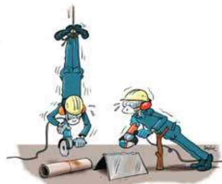
Tronçonner à 90°, meuler à 30°
